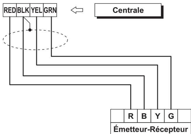
**Figure 23** Branchement de l'émetteur-récepteur avec la centrale.
