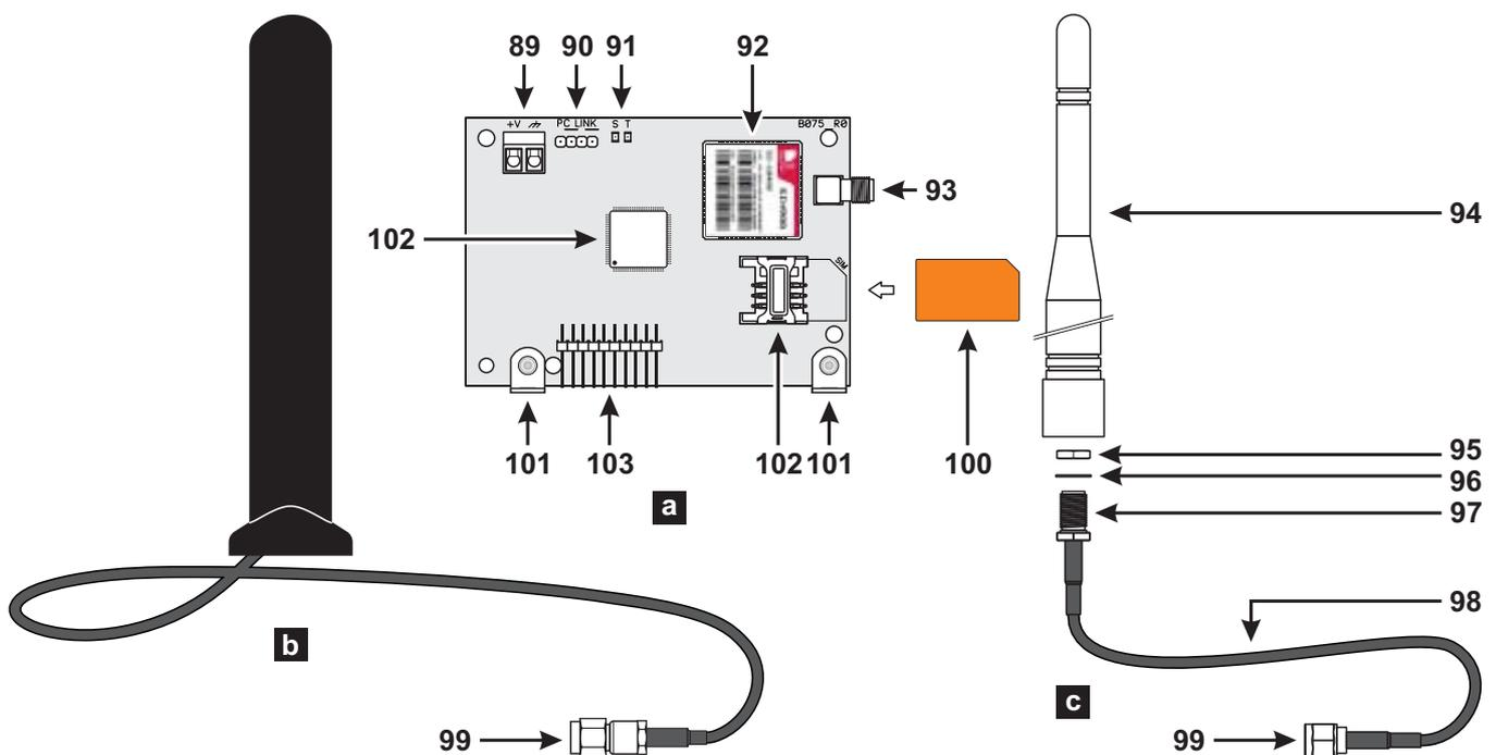
**Figure 6** Pièces du Module GSM **ABS-GSM** (a), de l'antenne pour boîtier métallique **BGSM-100CA** (b), de l'antenne pour boîtier en plastique **ABS-AK** (c).
