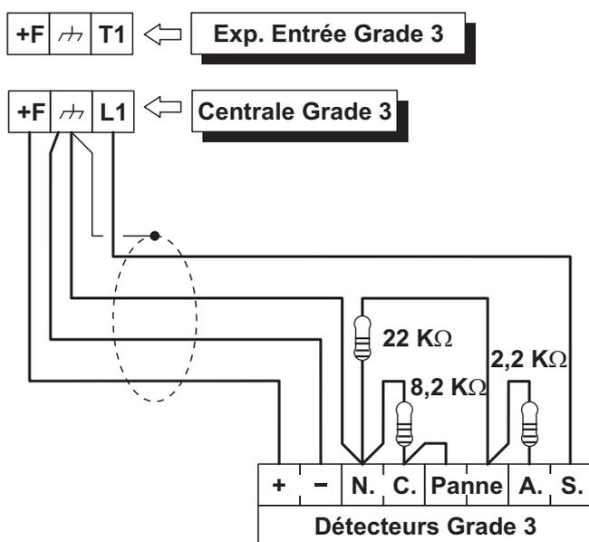
**Figure 14** Branchement d'un détecteur sur une zone avec Équilibrage **Triple End of Line**.
