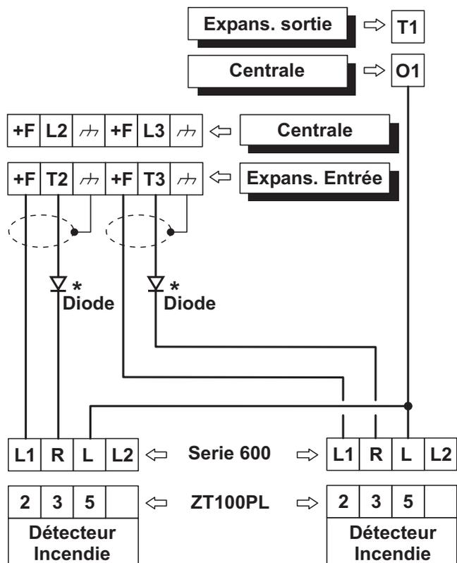
**Figure 16** Branchement de 2 détecteurs d'incendie sur des Zones avec Equilibrage Normalement Ouvert (\*uniquement avec la série 600).
