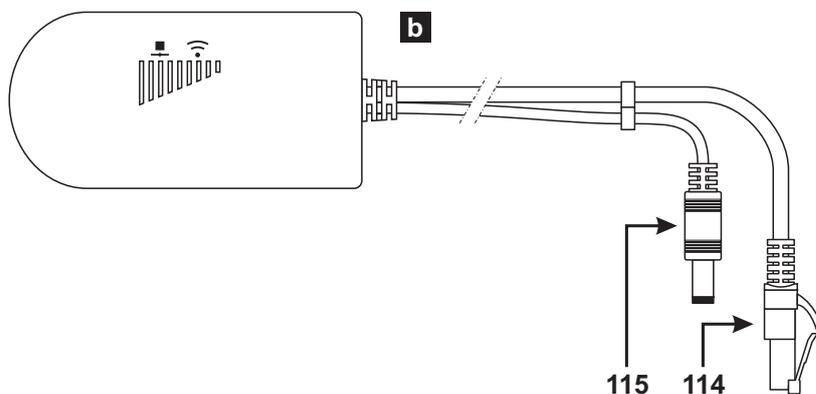
**Figure 7** Composants du Module IP **ABS-IP** (a) et du Pont Wi-Fi **ABS-VAP11G** (b).
